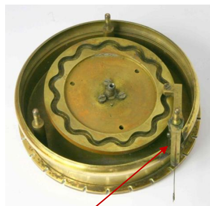
Longueur du levier : 101 mm Sa tête suit les ondulations.
