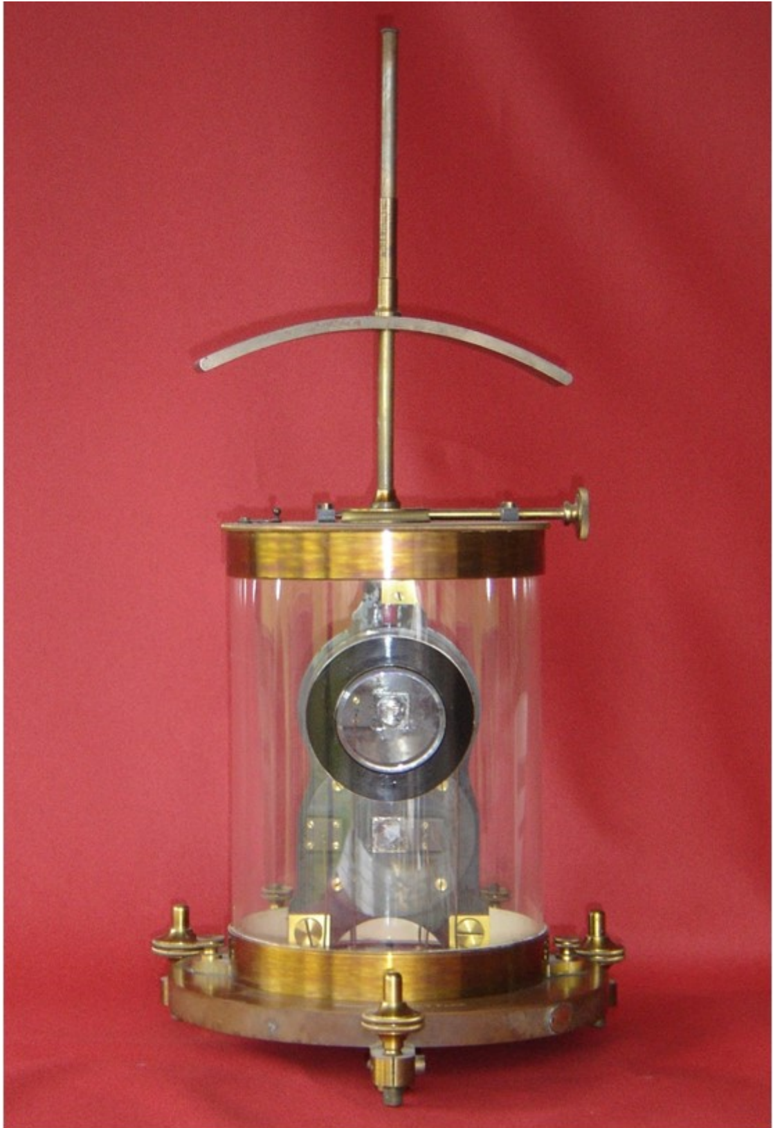
'Thomson' spiegelgalvanometer van Breguet
