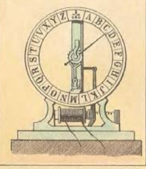
Les différents appareils de télégraphie utilisent tous cette propriété du fer doux. Dans le télégraphe à cadran, l'électro-aimant du poste récepteur attire à lui, à chaque passage du courant, un petit ressort dont le mouvement fait déplacer une aiguille sur un cadran présentant imprimées les lettres de l'alphabet.
