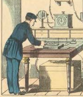
Dans le télégraphe Morse, le récepteur se compose essentiellement d'un électro-aimant devant lequel est placé un levier en fer doux mobile autour d'un point. Quand le courant passe, l'une des extrémités du levier est attirée par l'électro-aimant tandis que l'autre appuie, contre une molette chargée d'imprimerie, une bande de papier sans fin qui se déroule d'une façon continue. La molette imprime sur cette bande un trait ou un point suivant le temps plus ou moins long pendant lequel passe le courant. Morse a combiné ces traits et ces points de façon à former un alphabet complet, de sorte que, la transmission terminée, l'employé n'a plus qu'à traduire en langage ordinaire les signes conventionnels imprimés sur la bande de papier.
