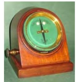
forme de chapelle à une aiguille. Les appareils des photos 9 et 10 ont le même aspect, mais dans la photo 9 c'est un petit télégraphe à une aiguille avec de petites butées qui limitent la déviation) tandis que dans 10 il est utilisé comme un galvanomètre (voir les graduations). La photo 11 est aussi un petit télégraphe à aiguille.
