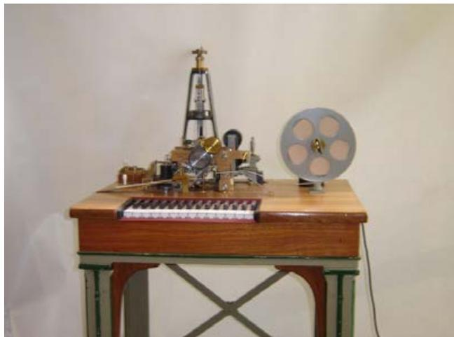
L'émetteur est composé d'un clavier « style piano ». Vingt-six touches portent l'indication d'une lettre et d'un chiffre ou caractère spécial. Deux autres touches commandent l'inversion lettres/chiffres. A chaque fois que l'opérateur déclenche une touche il envoie une impulsion électrique au poste. A la réception, l'impulsion déclenche la projection d'une bande papier sur une « roue des types » qui tourne en permanence. A ce moment précis, le signe est imprimé sur la bande. Il est évident que
