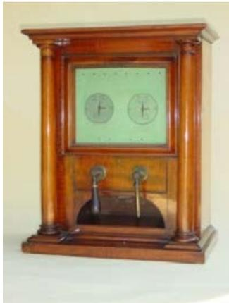
aiguille. Derrière l'aiguille se trouve une bobine dans laquelle passe le courant de réception. Suivant le principe découvert par le Danois Ørsted en 1820, l'aiguille tournera d'un côté lors du passage d'un courant négatif et de l'autre lors du passage d'un courant positif. Chaque caractère correspondait avec une séquence bien précise des mouvements de l'aiguille.
